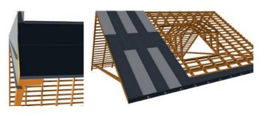
Anschließend das zu verbindende untere Blech durch Ausschneiden der Montagelöcher garen. 1
