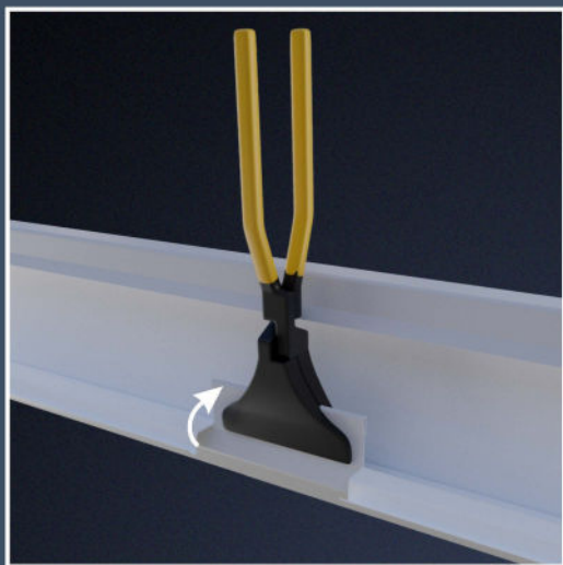
Umbiegen der Kante des Abdeckprofils.
