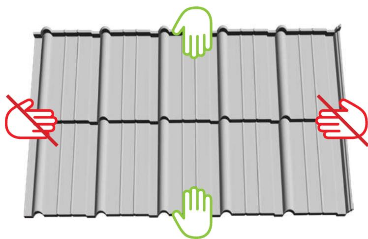
**Transport der Module.** Die Module sollten an ihren Prägungen getragen werden (grüne Farbe). Das Modul sollte nicht an seinen Rändern (rote Farbe) transportiert werden, da dies zu Lücken in den Längsüberlappungen führen kann.
