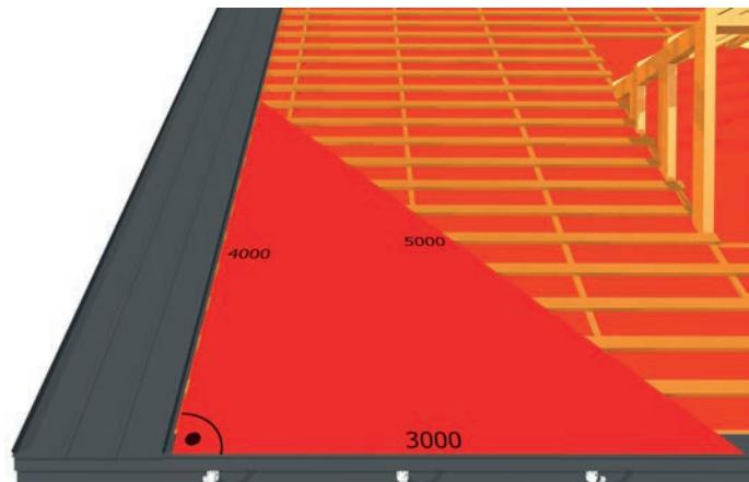
Mit der 3-4-5-Methode kann die Rechteckigkeit des Daches überprüft werden.
