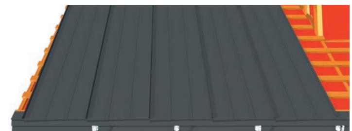
Beachten Sie unbedingt, die Dilatationsspalte einzusetzen (ca. 1 cm). Dadurch wird verhindert, dass das Panel das Lüftungsprofil bei niedrigen Temperaturen aufhebt.
