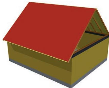
Bei der Bestellung von Blechen mit Unterfalz und Verwendung von perforiertem Lüftungsprofil ist eine Länge von 3 cm hinzuberechnen. Außerdem müssen die Diagonalen der Fläche überprüft werden. Wenn die Diagonalen ungleich sind, können kleine Unterschiede durch die Blechhaut ausgeglichen werden, bei großen Unterschieden sollte jedoch die Dachkonstruktion verbessert werden.
